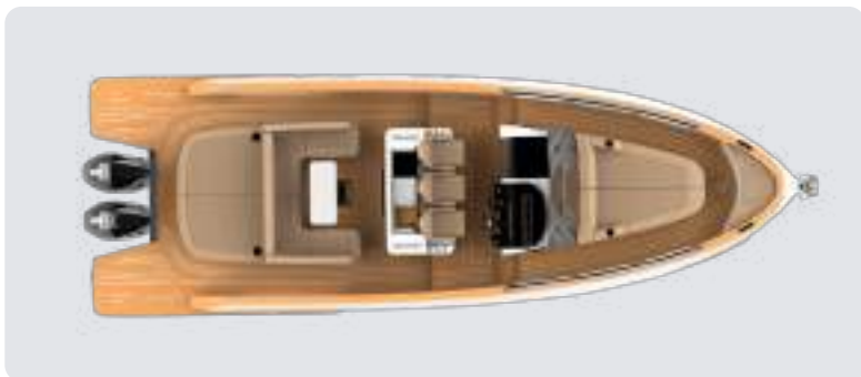
Distribución cubierta fueraborda.
